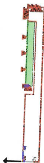
Figura 4.6 – Domínio Viável utilizado sendo que as restrições estão indicadas por triângulos, o stack está indicado pela região sombreada e o deslocamento desejado, pela flecha.
