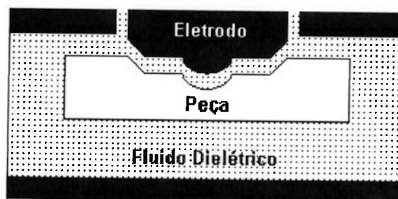
Figura 4.14 – Esquema simplificado de usinagem por EDM.
